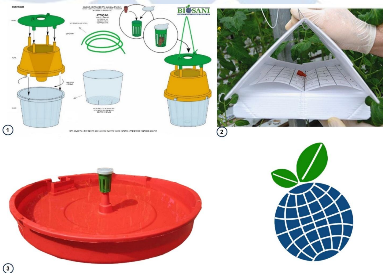
Figura 11.1 - Instruções de montagem do difusor na armadilha de funil (1), delta (2) e na de água (3).
