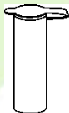
Figura 10.1 - Tubo de polietileno permeável contendo as feromonas. A tampa não deve ser aberta e o tubo deve ser instalado na vertical e com a tampa para cima, tal como apresentado na imagem.
