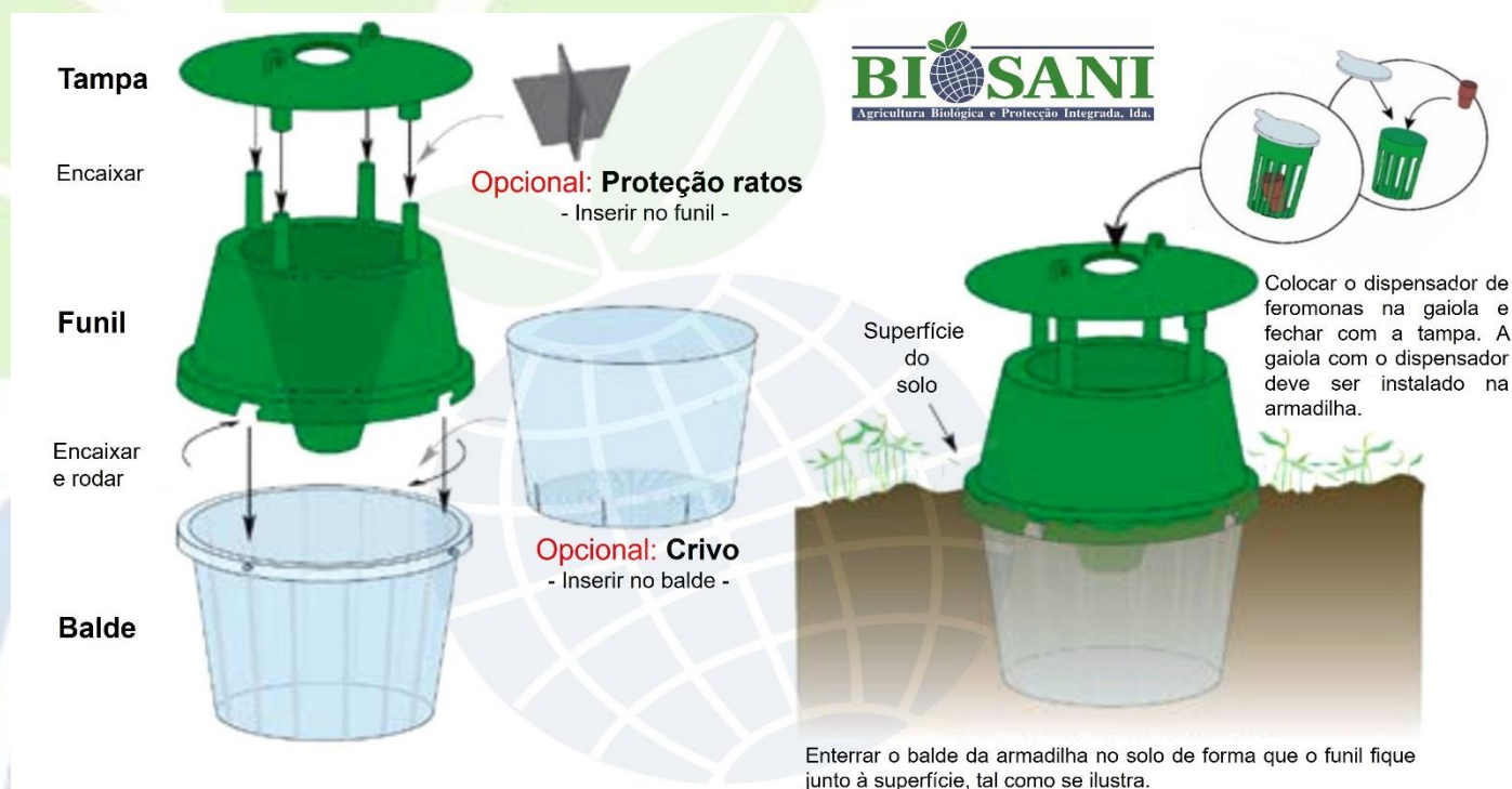
Figura 11.1 - Instruções de montagem da armadilha de funil e do dispensador de feromona.
