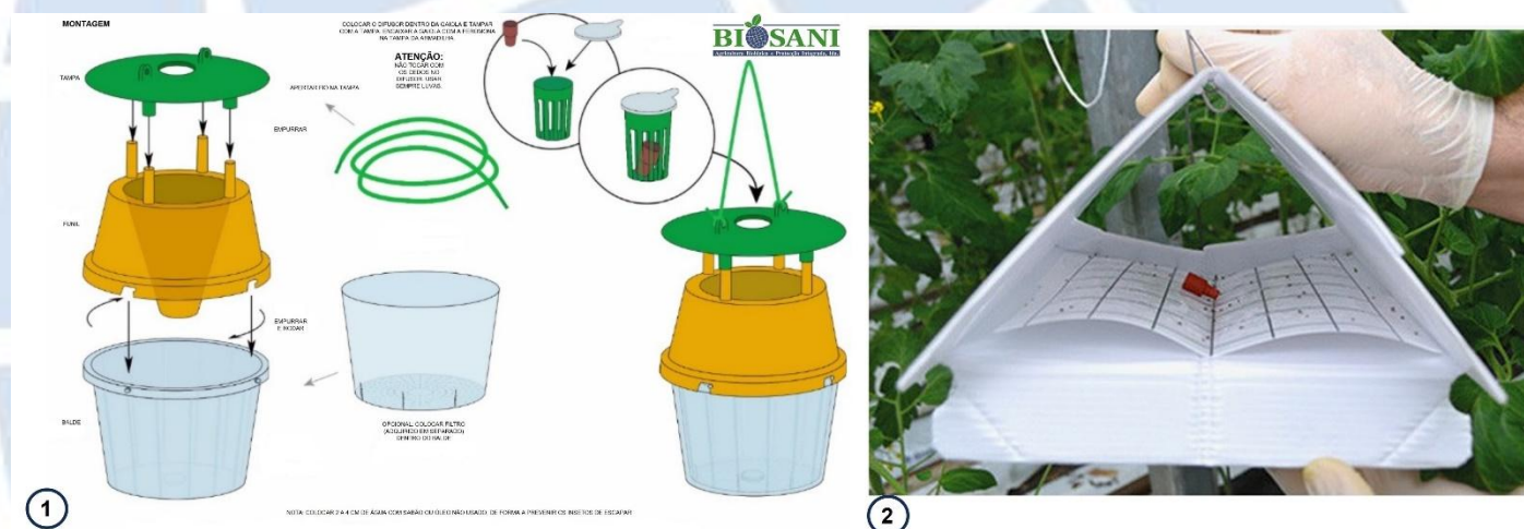
Figura 11.1 - Instruções de montagem do difusor na armadilha de funil (1) e na armadilha delta (2). O tubo de polietileno (Fig. 10.1) deve ser instalado na vertical e com a tampa para cima no interior da gaiola ou aderido na base de cola na armadilha delta. Nota: O difusor de tipo rolha de borracha representado nas imagens como exemplo, não corresponde ao difusor em tubo de polietileno que deve ser o utilizado para a monitorização da Busseola fusca .
